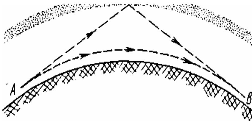
Рисунок 14 – Явление интерференции при распространении волн диапазонов НЧ и ОНЧ
